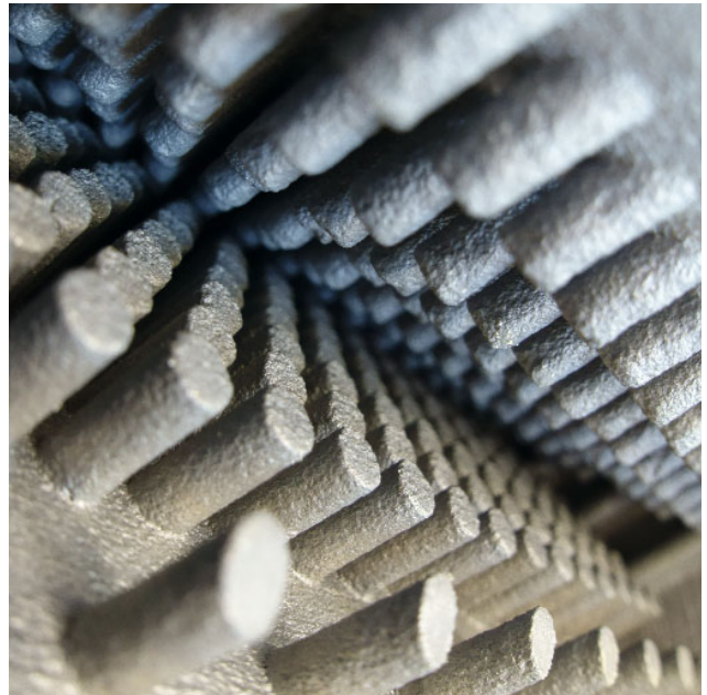
Detail des Wärmetauschers mit optimierten Oberflächen-Konturen
